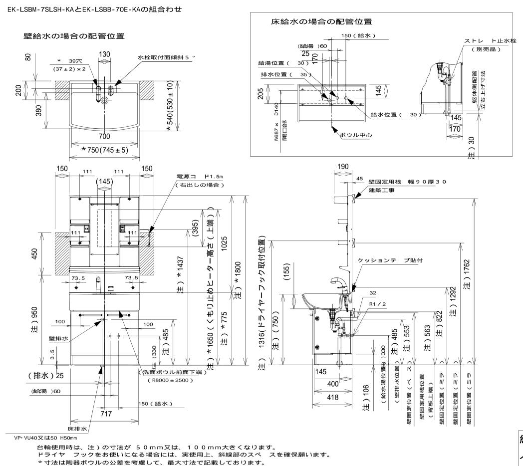
電源コードの取り出しが図面と逆の場合は、『電源コードの取り出し長さ(mm)=1500(mm)-間口寸法(mm)"となります。
